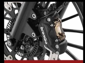
**BREMBO 4 PISTON FRONT CALIPER**
